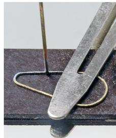
Antriebsriemen zum Lackieren (schwarz) an einen 0,5mm Draht löten.
