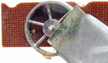
1mm Draht einlöten, an beiden Seiten überstehend (anders als auf dem Foto zu sehen) und in der Bohrmaschine von beiden Seiten glätten.
