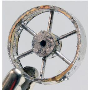
Zweite Felge und Nabe anlöten. Bei der Nabe darauf achten, dass die durchgehende Nut mit der durchgehenden Speiche übereinstimmt. Nabe aufbohren (1mm).
